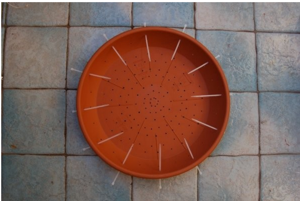
Il sottovaso con le 12 fascette inserite nelle asole realizzate con il disco
