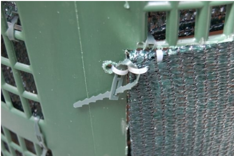
Le fascette verdi usate per chiudere gli sportellini in maniera reversibile.
